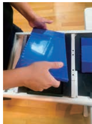
⑤古いバッテリーを取り出し新しいバッテリーを入れます。バッテリーコードを取り付けたらバッテリー交換完了です。
