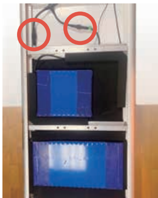
④2カ所のバッテリーコードを取り外します。
