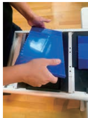
⑤古いバッテリーを取り出し新しいバッテリーを入れます。 バッテリーコードを取り付けたらバッテリー交換完了です。
