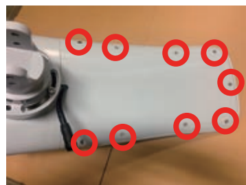
④六角レンチで9カ所のボルトを取り外します。
